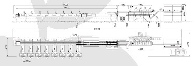
Exemple d'une ligne de triage d'avocats, avec godet P.152, des sorties réversibles, pour l'emballage sur les tables banque ou pré-calibrer au même temps. Production 57000 pièces / heure environ.
